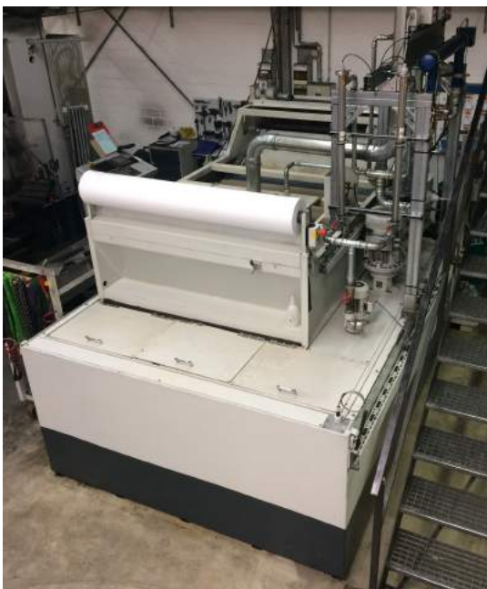
Bild: Schrägbettfilter mit AQON Hi' Tension
