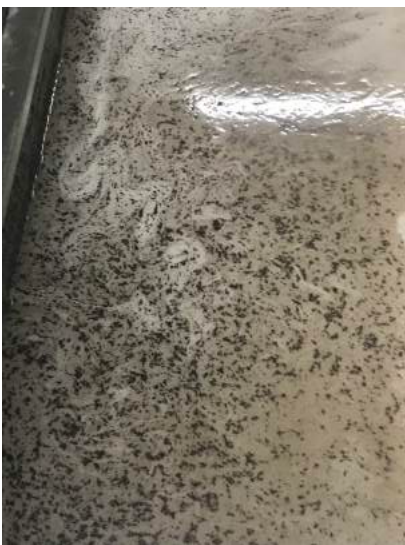
Bilder: Aufschwimmende, agglomerierte Partikel (links), Filterkuchen (rechts)
